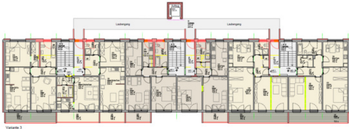
Abb. 68: Grundriss zu Var 3 mit Grundrissoptimierung und Laubengang für zentralen Aufzug (Quelle: IBNuP)
