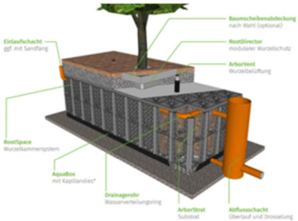
Abb. 88: Beispiel2 für Baumrigolen in unbefestigten und befestigten Flächen „Arborflow“ (Quelle: greenleaf)
