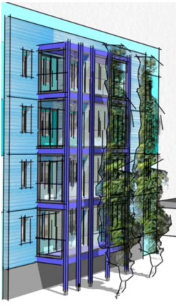
Abb. 53: schematische Perspektive optionaler Umbau Balkone zu Wintergarten (Quelle: IBNuP )
