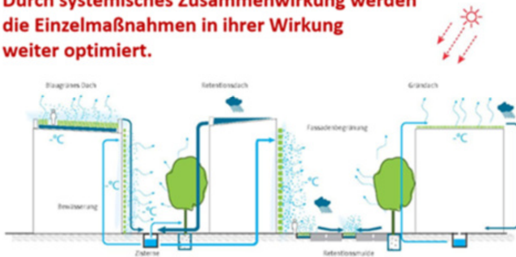
Abb. 89: schematische Darstellung zum Regenwassermanagement (Quelle: STEP Klima Konkret, 2016, bgmr,i.A. SenStadtUm, Berlin)
