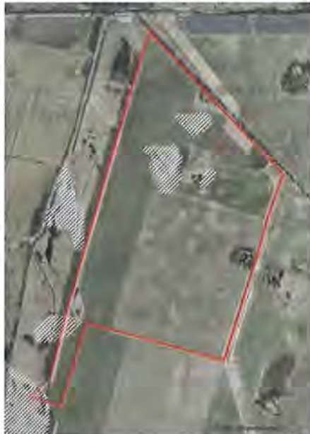
Abb. Lage der Torflinsen im Plangebiet
